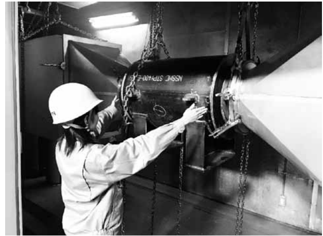
写真1 サイレンサー試験風景
