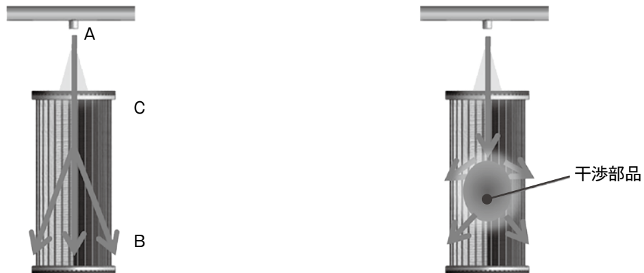
図2 従来型集塵機の払落し効果のイメージ
