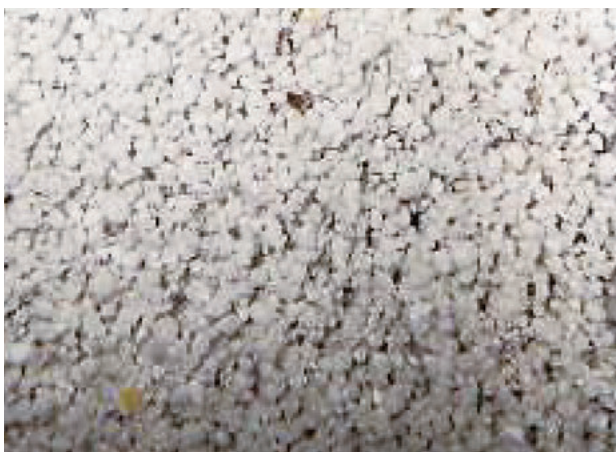
図3 ペレット状のフロック（運転①）
