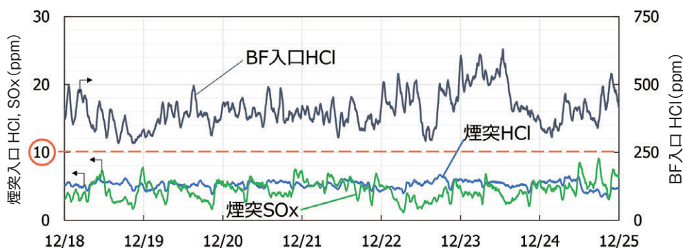
図2 本申請システム運転時のHClとSOxの1時間平均値の挙動 (HCl及びSOx濃度は酸素12%換算値)
